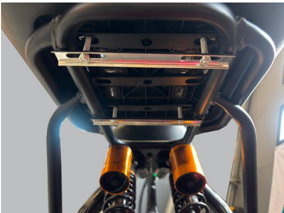
Pujota kiskot ja mutterit paikalleen. Säädä boksi suoraan ja kiristä kiinnityspultit (ristipäämeisseli ph2).
